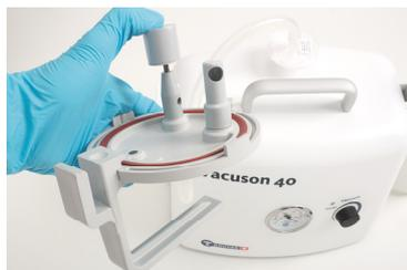
1. Conecte la tapa de la botella de aspiración sin botella con la unidad de control a través del tubo de conexión (8 x 3 x 400 mm).
