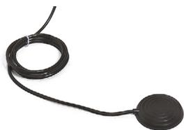
Cuando el pedal neumático incluido en el suministro del Vacuson 40/60 se pisa, se activa un interruptor en el aparato para encender o apagar la bomba. Esto se produce a través de un colchón neumático.
