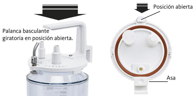
3. Girar 180° la palanca basculante giratoria de la tapa de la botella de aspiración (la palanca apunta en el sentido contrario al asa de la tapa). Comprobar que el pasador agarra por debajo del reborde de la botella de aspiración.
