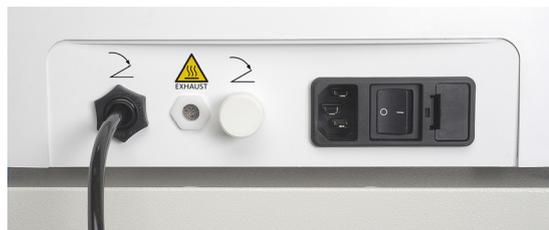
4. El pedal Vario-AIR se conecta a la conexión en la parte posterior del equipo a través del tubo de conexión. (Si el pedal Vario-AIR no se va a utilizar es necesario poner de nuevo la tapa porque, de lo contrario, no se puede formar el vacío).
