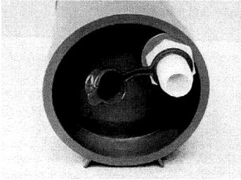
En la fotografía de la izquierda se muestra la rosca de entrada del filtro de amalgama. Como se puede apreciar, la rosca de entrada está en un lateral. Esta parte está conectada al sistema de aspiración HVE que viene del paciente. Lleva un conector de 15,9 mm con tapa de vinilo roja. En el momento en el que sea necesario reemplazarlo porque esté lleno de residuos, la tapa roja se coloca en el conector para prevenir cualquier tipo de fuga.
