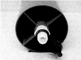
En esta foto se muestra la rosca de salida. Como se puede apreciar, dicha rosca se encuentra en el centro. Esta parte es la que va conectada a la bomba de aspiración. Lleva un conector de 15,9 mm con tapa de vinilo roja. En el momento en el que sea necesario reemplazarlo porque esté lleno de residuos, la tapa roja se coloca en el conector para prevenir cualquier tipo de fuga.
