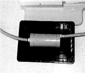
El filtro se debe cambiar siempre que los niveles de aspiración sean más bajos de los recomendados. El filtro usado (todavía conectado a las mangueras de aspiración) se debe colocar encima de una bandeja para recoger cualquier resto de agua residual que se pueda verter y evitar así el contacto con el suelo de la clínica.
