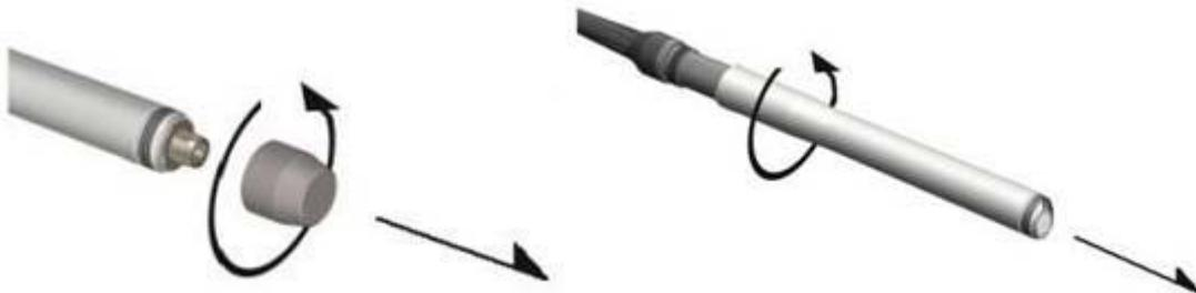
Para extraer el cilindro, destornillar el tapón de protección o extraer el tip. Destornillar el cilindro del cuerpo principal. Puede ser esterilizado como indicado en el párrafo anterior.
