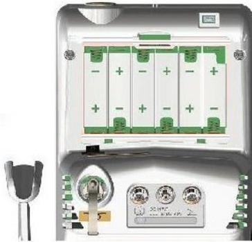
Si el láser no se carga correctamente, puede ser necesario reemplazar las 6 baterías recargables contenidas en el alojamiento posterior del láser. Se sugiere, de todas formas, reemplazar las baterías después de un año de uso, para asegurar un correcto funcionamiento del dispositivo. Para las especificaciones, contactar con el proveedor. Usar exclusivamente baterías LAACS077.6 de LAMBDA o procedentes de proveedores autorizados (6 AA, 1,2V 2000mAh NiMH recargable).
