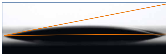
V-Posil Light Fast / V-Posil X-Light Fast / V-Posil Mono Fast – ángulo de contacto bajo <math>< 10^\circ</math>
