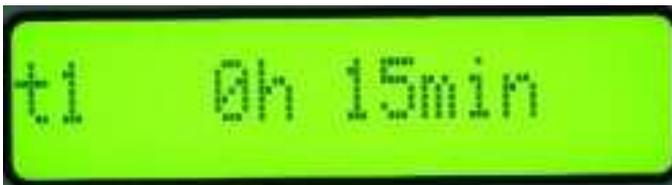
Configurar el tiempo de estacionamiento t1 de la primera fase. Configurar las horas con ENTER, configurar los minutos, confirmar con ENTER y pasar a la fase sucesiva con T2. De la misma manera se configuran las fases sucesivas. Después de haber configurado el tiempo de mantenimiento de la última fase, pulsando ENTER se pasa a:
