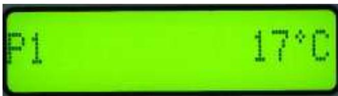
En la parte izquierda se indica el último programa realizado o modificado (P2 o P1) y, en la parte derecha se indica la temperatura interna.
