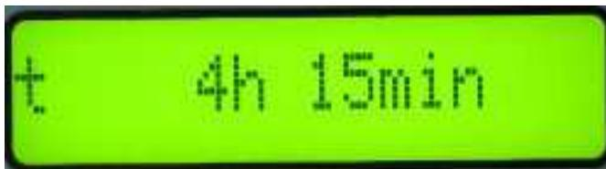
Configurar el tiempo de estacionamiento t, configurar las horas y confirmar con ENTER. Configurar los minutos, confirmar con ENTER y pasar a:
