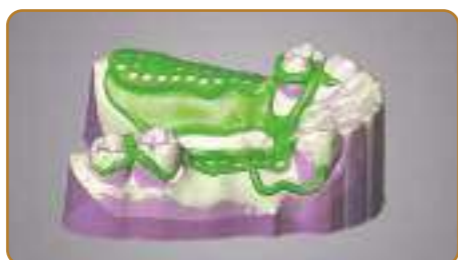
Détection automatique des contre-dépouilles Automatic undercut detection Detezione automatica dei sottosquadri
