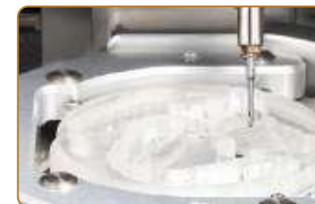
Usinage 5 axes à sec 5 axis dry grinding 5 assi lavorazione a secco
