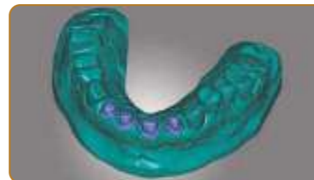
Créer des modèles physiques d'après des numérisations d'empreintes dentaires Creation of models on digital tray Creazione di modelli su base impronta numerica
