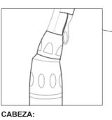
Para sacar la cabeza y realiza un mantenimiento correcto, debemos de girar su base hacia el lado derecho, una vez fuera, debemos de prestar mucho atención de no perder ninguna parte y de volver a instalarlo de forma correcta.
