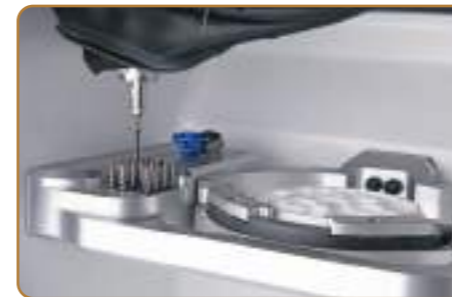
Changeur automatique 17 outils Automatic tool changer 17 tools Caricatore automatico 17 utensili
