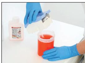
Volver a enroscar el cabezal de la bomba en el recipiente (girando en el sentido de las agujas del reloj) y ponerlo en la carcasa
