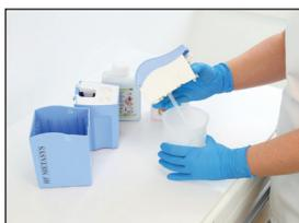
Sacar el dosificador de la carcasa y retirar el cabezal de la bomba (girando en el sentido contrario a las agujas del reloj)
